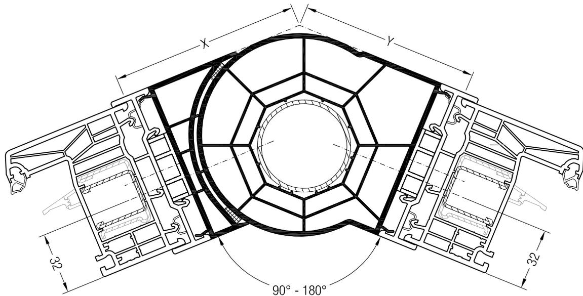
Bitte beachten Sie: Bei verstellbaren Verbindungspfosten bestimmt der Winkel des Pfostens die Maße für "X" und "Y" - in der nachstehenden Tabelle finden Sie eine Übersicht über die Maße von "X" und "Y" in Abhängigkeit vom Winkel.
